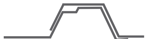
DETALLE DE SOPORTE LONGITUDINAL
